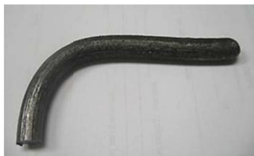
Рис. 4. Образец хромоалюминиевой стали после прессования в виде изогнутого прутка
