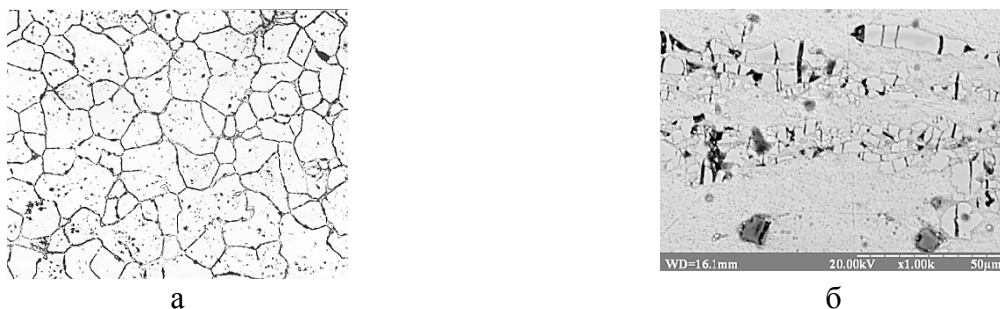
Рис. 5. Микроструктура хромоалюминиевой стали в литом состоянии (а) и после деформации (б)
